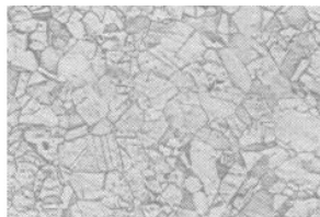
příčná část OFC 200X
